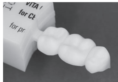
図1 削り出したCAD/CAM人工歯
