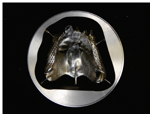
図1 切削加工後のチタンディスク(症例1)
