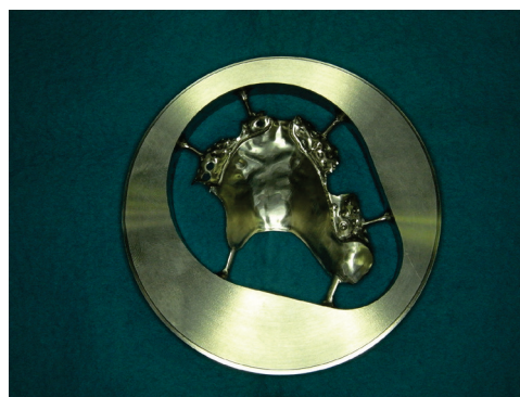
図2 切削加工後のチタンディスク(症例2)
