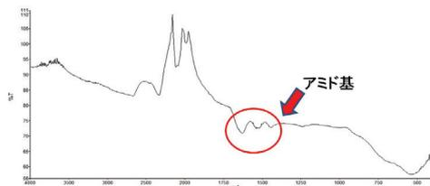
図 実験群材料表面のFTIR解析結果
