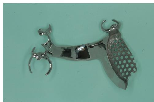
図2 積層造形により製作したフレームワーク
