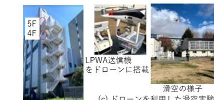
(a) アンテナの配置場所 (b) LPWA送信機をドローンに搭載 (c) ドローンを利用した滑空実験 (建物遮蔽効果の緩和を確認)
