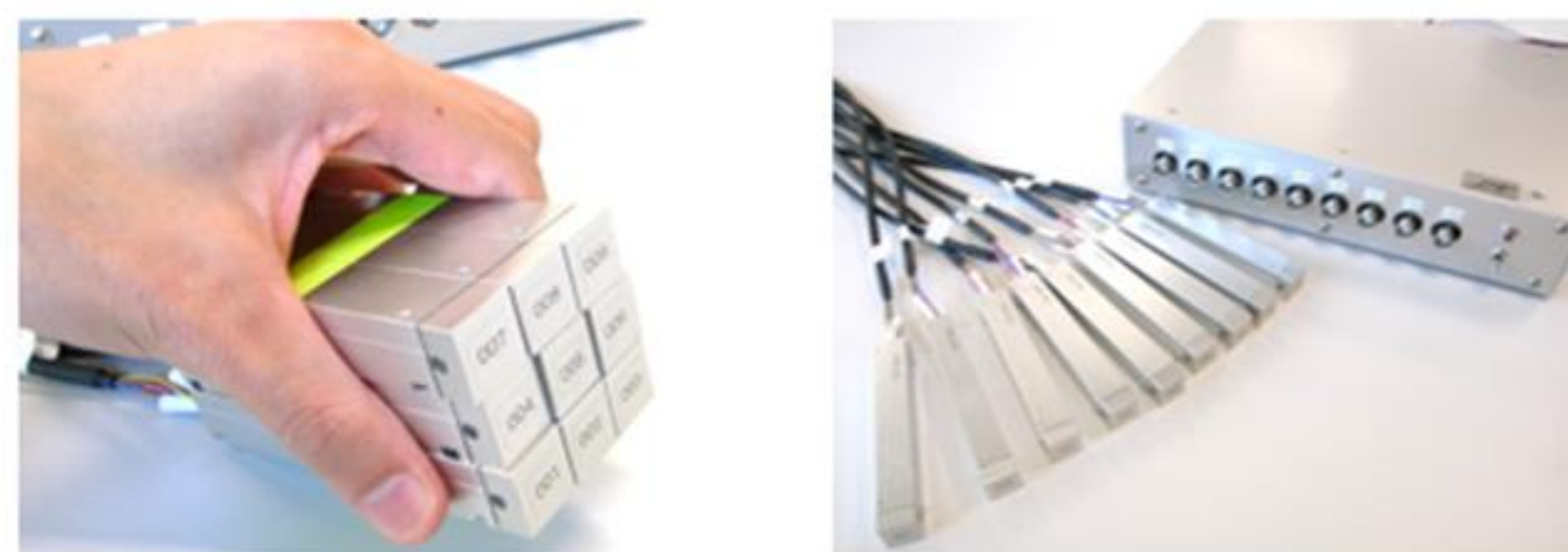
図2 制作した9チャンネルTMR磁気センサモジュール
