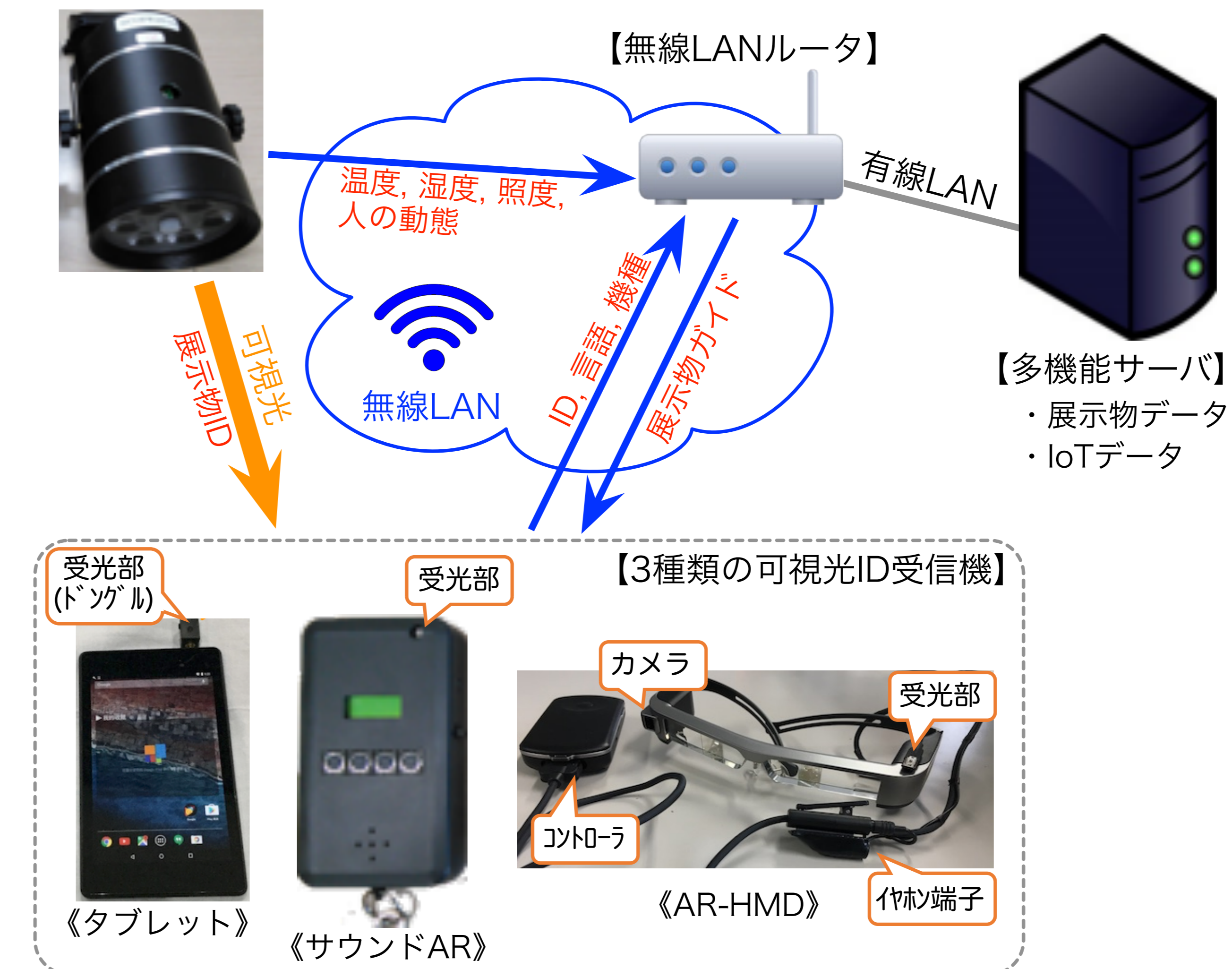
図1 可視光ビーコンガイドシステム概念図
