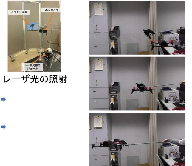
図7 ドローン搭載カメラによる鳥の自動追尾 図8 格納ステーションからのドローンの自動離発着
