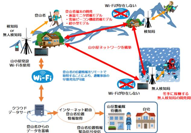
150MHz帯電波を用いた登山者位置検知システムの評価モデル
