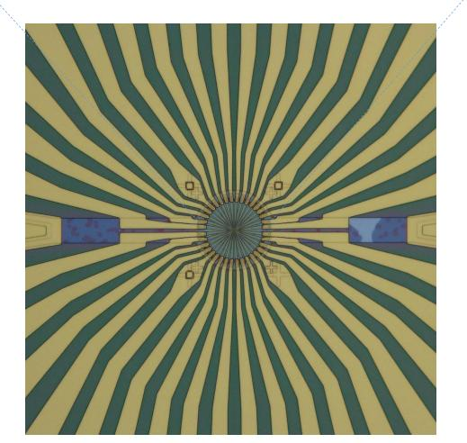
電子線リソグラフィーを用いて 作製したナノドットアレイリ ザーバと磁化状態検出用配線
