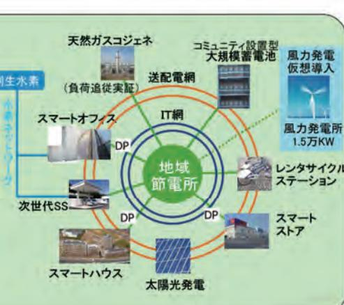
小さなエンジンによる火力発電の一種であるコーディエネは、分散型電源の大きな柱です。電気と一緒に熱を生むコーディエネレー・ション、略してコーディエネです。一番身近なコーディエネは自動車です。内燃機関に燃料を入れ電気を作ると同時に蒸気や温水を取り出し車内の冷暖房に使います。
